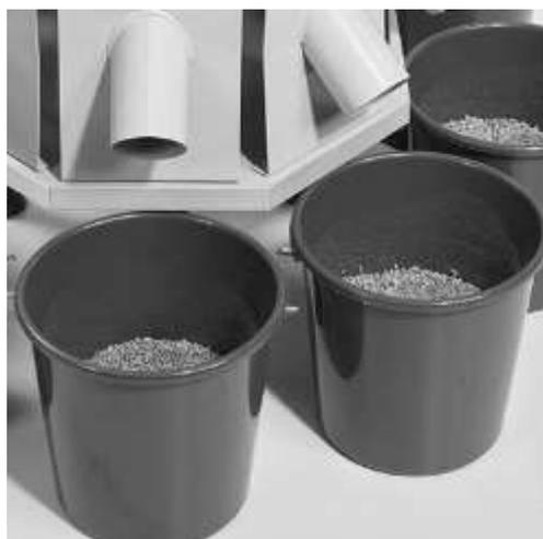
Для подготовки однородных межлабораторных образцов, контрольных образцов для внутреннего контроля и регулярных сравнительных измерений. Фиксированное соотношение деления.
